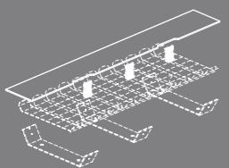
**sportello singolo** - single flap with netting trough - top accès simple avec panier à grille - einzelne Klappe mit Kabelwanne aus Metallnetz - tapa simple con bastidor de red - portinhola individual com grelha passa-cabos
