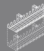
**cestello posacavi in rete per tavolo singolo (sovrapponibile)** - cable tray for single top (can be stacked) - panier à grille pour bureau simple (superposable) - Kabelwanne aus Metallnetz für Einzeltisch (Montage übereinander möglich) - bastidor cablero de red para mesa simple (superponible) - grelha passa-cabos para mesa individual (de sobrepor)
